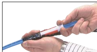
...Werkzeug in Schlauch einführen, verriegeln und ziehen...
