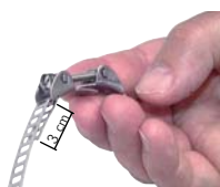
...Schraubschloß einhängen und ca. 3cm hinter das Hauptband zurücklegen...
