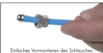
Einfaches Vormontieren des Schlauches.
