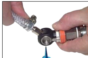
Kupplung ausschwenken - Kupplung schließt und entlüftet
