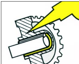
Typ 2RS Abgedichtet mit berührenden Dichtungen
