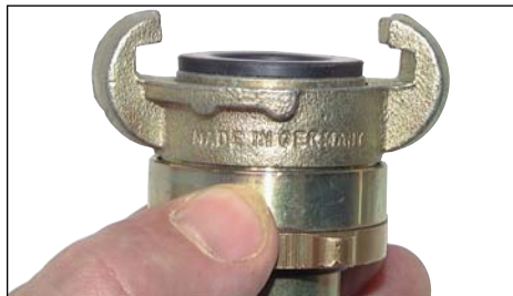
Vorgeschraubte Dichtung - Verbindung ist dicht.
