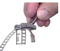
...Hand-Spannschloß einhängen und ca. 3cm hinter das Hauptband zurücklegen...
