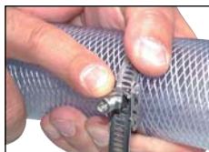
Schloß öffnen und Band positionieren, ...
