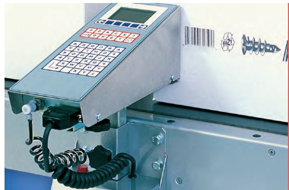
Merlin Tintenstrahldrucker haben Winkel-Stecker, die das Schlauch-Handling vereinfachen.
