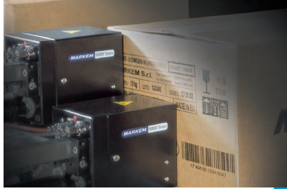
MARKEM® Tintenstrahl drucker haben verchromte Messingkupplungen zum schnellen Austausch der Druckköpfe
