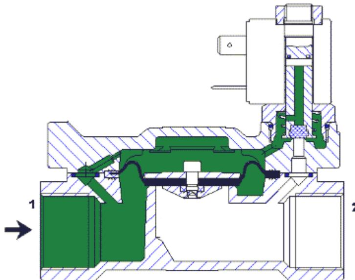
Der Elektromagnet ist stromlos und sein Anker verschließt die Abbaubohrung (Vorsteuersitz). Der Eingangsdruck in 1 (größer als Ausgangsdruck in 2) baut sich durch die Aufbaubohrung in der Membrane auf der Membranoberseite auf. Dieser Druck, multipliziert mit der Fläche der Membranoberseite erzeugt eine Schließkraft, welche größer ist, als die auf die Membrane wirkende Öffnungskraft. Sie wird auf ihren Sitz gepresst.
