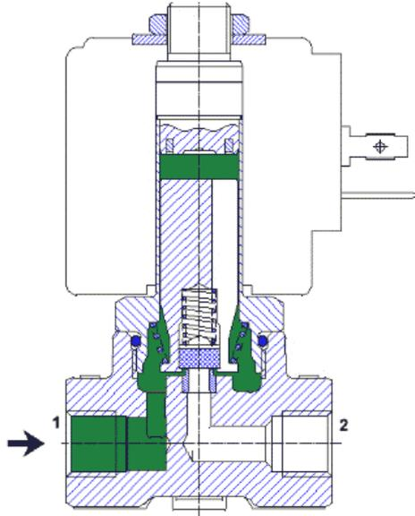
Der maximale Betriebsdruck und der Volumenstrom hängen direkt vom Sitzdurchmesser (DN) und der Magnetkraft ab.
