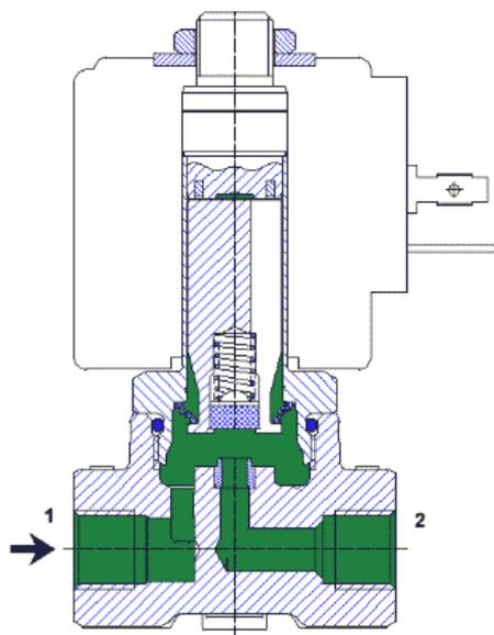
Der maximale Betriebsdruck und der Volumenstrom hängen direkt vom Sitzdurchmesser (DN) und der Magnetkraft ab.
