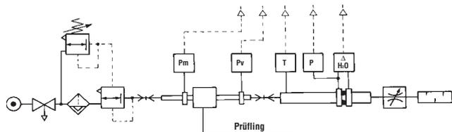
• Durchflussprüfung der Abteilung Mechanik, des Polytechnikums von Turin, mit einer Computermesseinrichtung gemäß CETOP RP50R, (ISO DIS 6358-2 konform) mit einer ISO 5167 Messblende.
