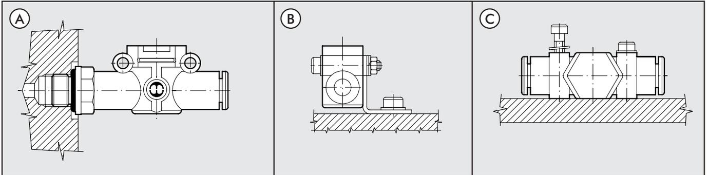
Abb. A: Mit dem Außengewindeanschluss ist es möglich den VNR L direkt am Zylinder zu befestigen.
