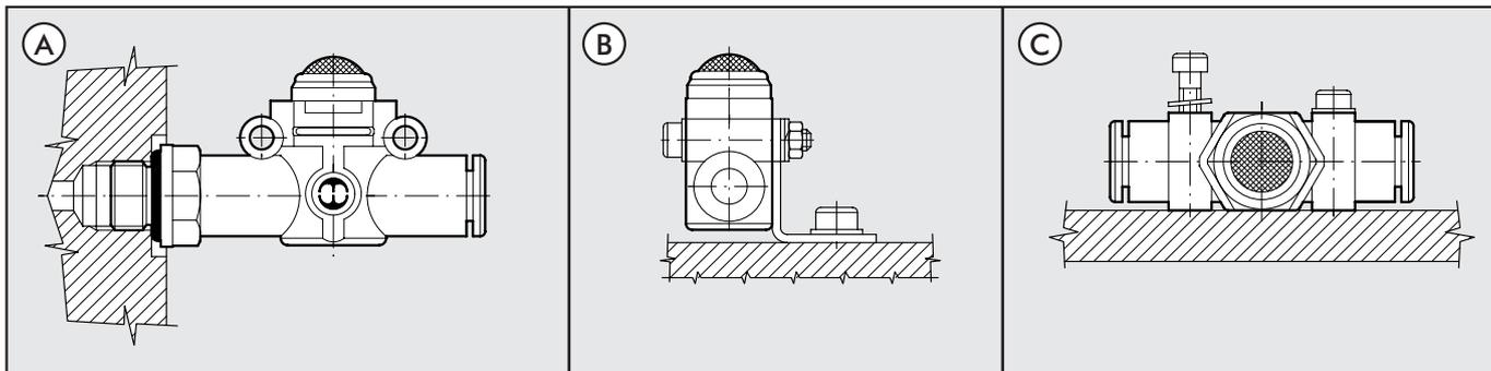
Abb. A: Mit dem Außengewindeanschluss ist es möglich den VSR L direkt am Zylinder zu befestigen.
