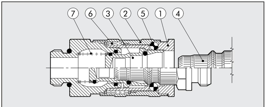
Die aktuellen Kupplungsstecker haben keine seitlichen Löcher. Die können nicht mit den Handkupplungen der älteren Produktion verbunden werden.
