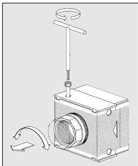
Die Serie 400 beinhaltet ein patentiertes System mit Dreh-Gleitstück, somit werden keine lösbaren Doppelnippel benötigt. Bei der Montage (Demontage) zuerst die Innensechskantschraube lösen und dann den Dreh-Gleit-Einsatz.
