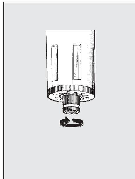
Durch Rechtsdrehung der Verschraubung kann der Ablass blockiert werden.
