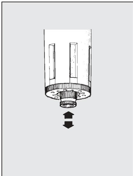
Der halbautomatische Ablass ist drucklos geöffnet. Bei Druckbeaufschlagung schließt dieser. Somit wird bei Drucklosigkeit der Behälter entwässert.
