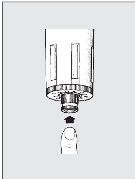
Durch Fingerdruck auf die Verschraubung kann manuell eingegriffen werden.
