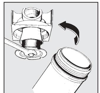
**REINIGUNG BZW. WECHSEL DES FILTERELEMENTS**
