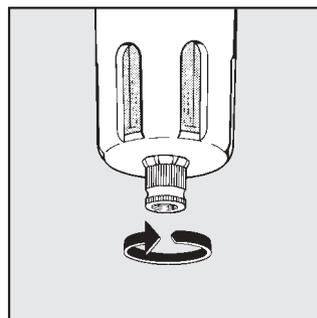
Durch Rechtsdrehung der Verschraubung kann der Ablass blockiert werden.
