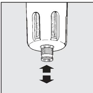
Der halbautomatische Ablass ist drucklos geöffnet. Bei Druckbeaufschlagung schließt dieser. Somit wird bei Drucklosigkeit der Behälter entwässert.
