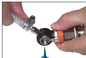
Kupplung ausschwenken - Kupplung schließt und entlüftet
