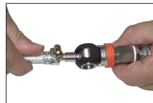
die Kupplung ist verriegelt und hat vollen Durchgang.
