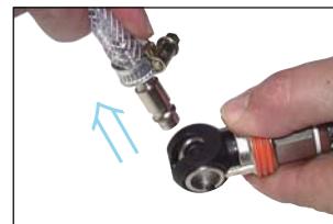
Stecker wird drucklos entnommen.
