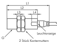
Typ mit Kabel, nicht bündig einbaubar
