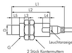
Typ mit Stecker, bündig einbaubar
