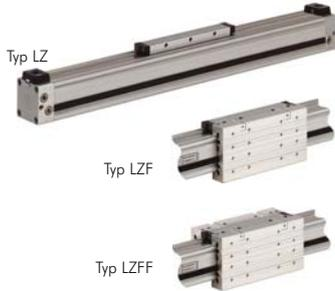
**Bauart:** kolbenstangenloser Zylinder mit direkter Kraftabnahme durch den Rohrschlitz auf die Kraftbrücke, beiderseits einstellbare Endlagendämpfung, austauschbar mit vielen anderen Herstellern
