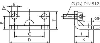
\* die Zylinder NXD & NXE Ø 12 bis 25 haben nur ein Befestigungsloch. Wir raten daher von einer Verwendung dieser Fußbefestigungen für diese Abmessungen ab.
